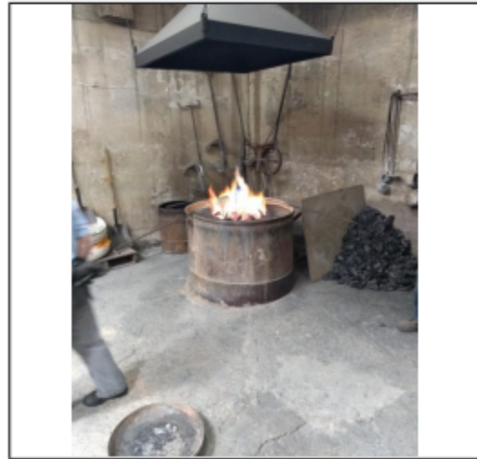
Fotografía 2: Crisol en operación
